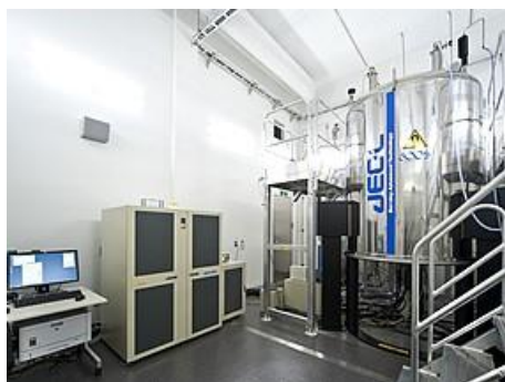
図 1 800MHz NMR スペクトロメータ 「ECA800」(JEOL RESONANCE 製)
