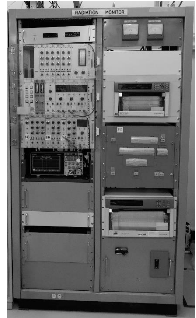
図 1 更新前の放射線安全管理用ラック。古い測定回路(ラック左側)と記録印刷用プロッター(ラック右側)
