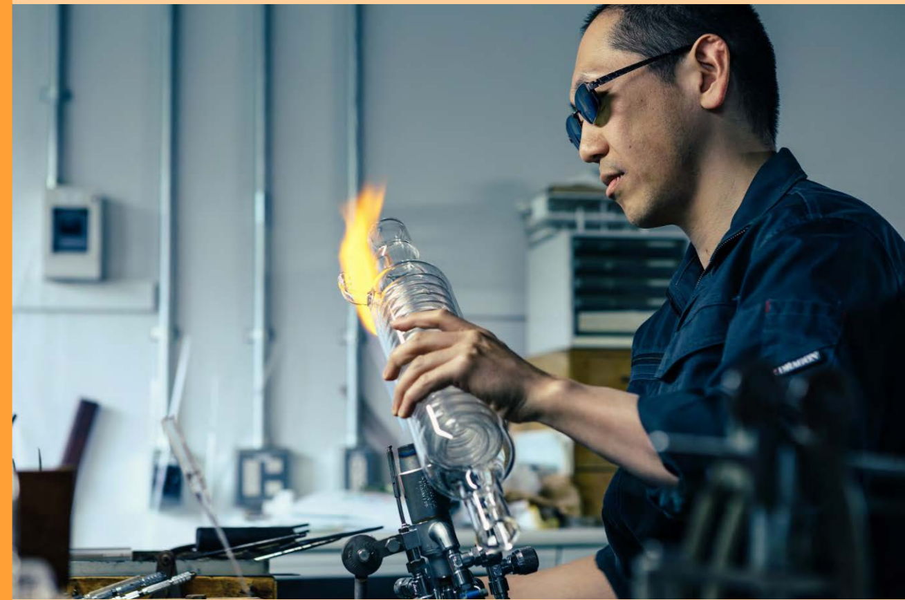
▲理化学ガラス器具のバーナー加工
