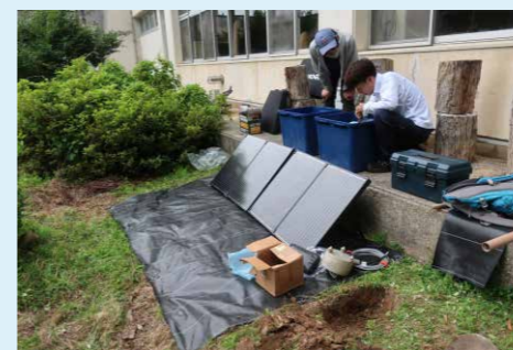
▲能登半島臨時地震観測において、石川県珠洲市で地震計を設置した時の作業風景。ソーラーパネルとモバイル回線でデータ伝送を行うオンライン臨時地震観測システムを設置した。
