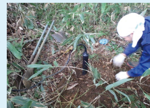
▲写真中央の地面に埋められた棒状の機器は、地磁気を計測するためのセンサ(全長およそ1.0 m)である。
