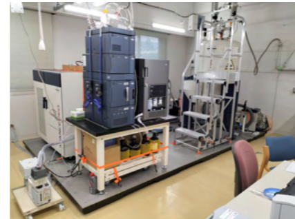
▲ 免振台上に設置された装置類
