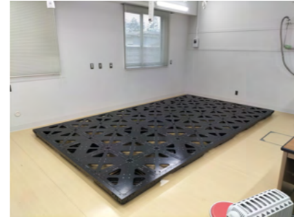
▲ 敷設された免振台
