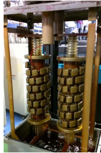
▲ 反射電力吸収用シャントダイオード
