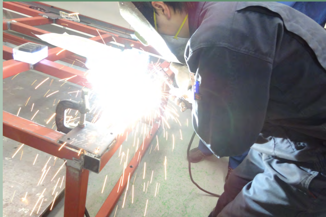
▲アーク溶接での架台製作の様子
