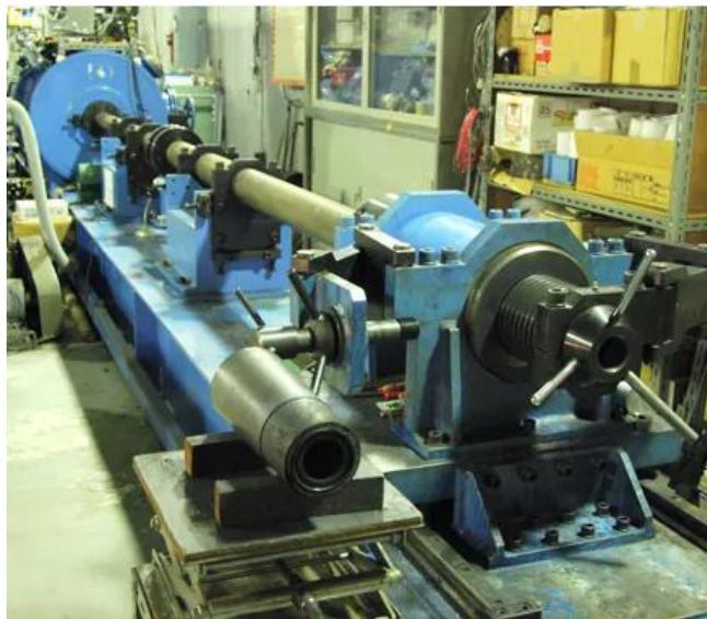
図 3. 小惑星衝突実験に使用した一段式火薬銃 (物質材料研究機構設置)
