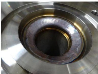
図6 溶接箇所の上からさらになめ付け
