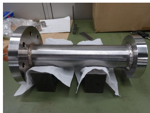
図 12 完成した圧力容器
