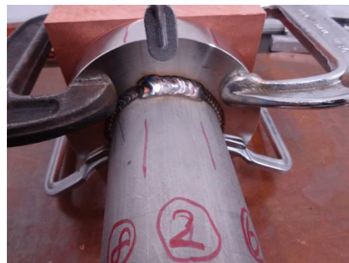
図 10 なめ付け後の本溶接
