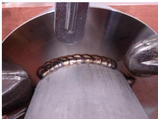
図 9 パルスでなめ付け溶接
