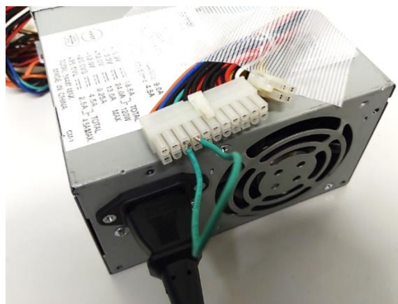
図 1 電源ユニットを単体で起動させている様子
