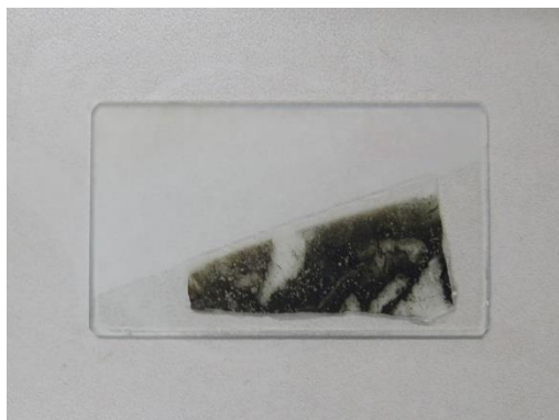
図 2 削り過ぎて上側の半分が欠損した薄片
