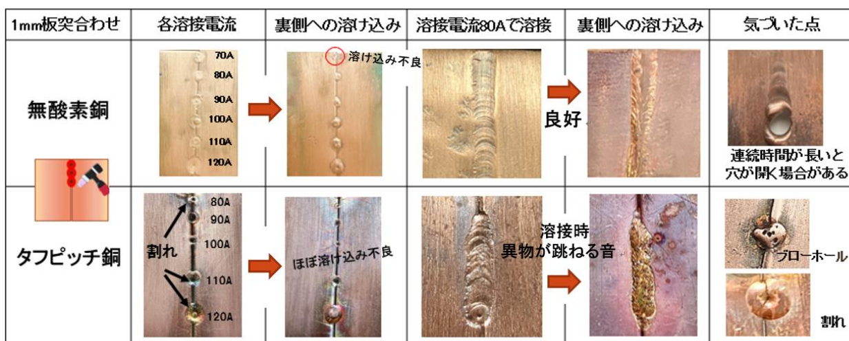
図 2 無酸素銅とタフピッチ銅の溶接性を比較
