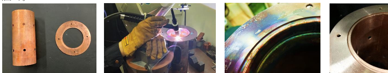
図 7 フランジと円筒の溶接
