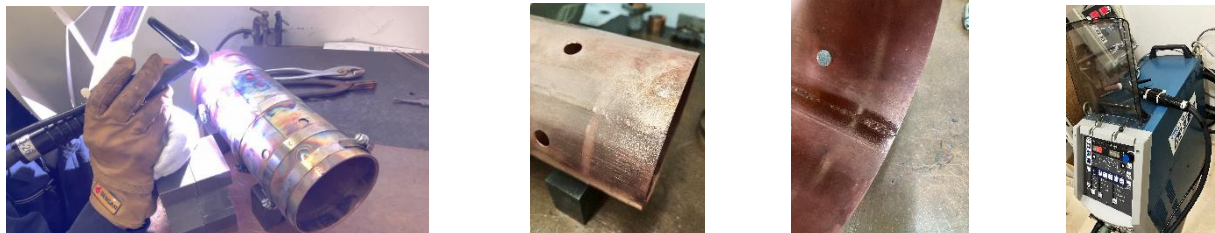
図 6 溶け落ちに注意しながら溶接をしていく工程
