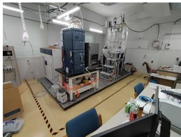
図2 免震台上に設置された装置類
