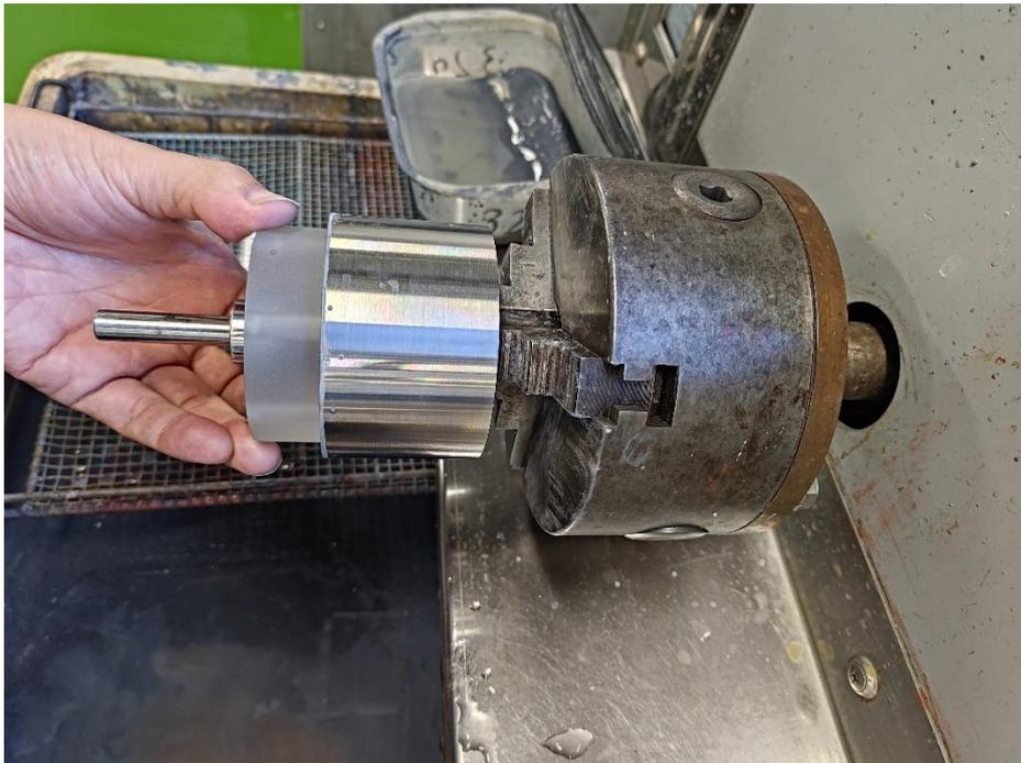
・独自の治具を用いた研磨作業の様子
