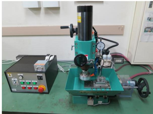
図1 薄片作製装置 プレパラップ
